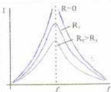
Σχ. 1.30 Τα διαγράμματα του πλάτους της έντασης του ρεύματος  $I$  της πίνακας  $LC$  που εκτελεί εξαναγκασμένη πλευρική παντούτων σε συνάρτηση με τη σύγχρονη τιμή της διαπέρανη για διάφορες τιμές της αντίστασης του κυκλώματος ( $R_1 < R_2$ ).
